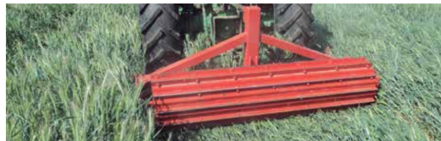
Fig. 4: Rolado de gramíneas con rolo experimental de cuchillas planas y sin filo (T. Baigorria).
